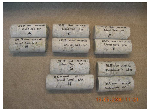
Belebungsbecken: gewonnene Bohrkern
