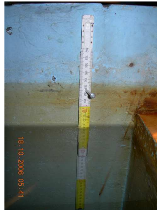
HB Mitterberg: Feststellung der Wasserverluste und Prüfung der Entnahmeleitung
