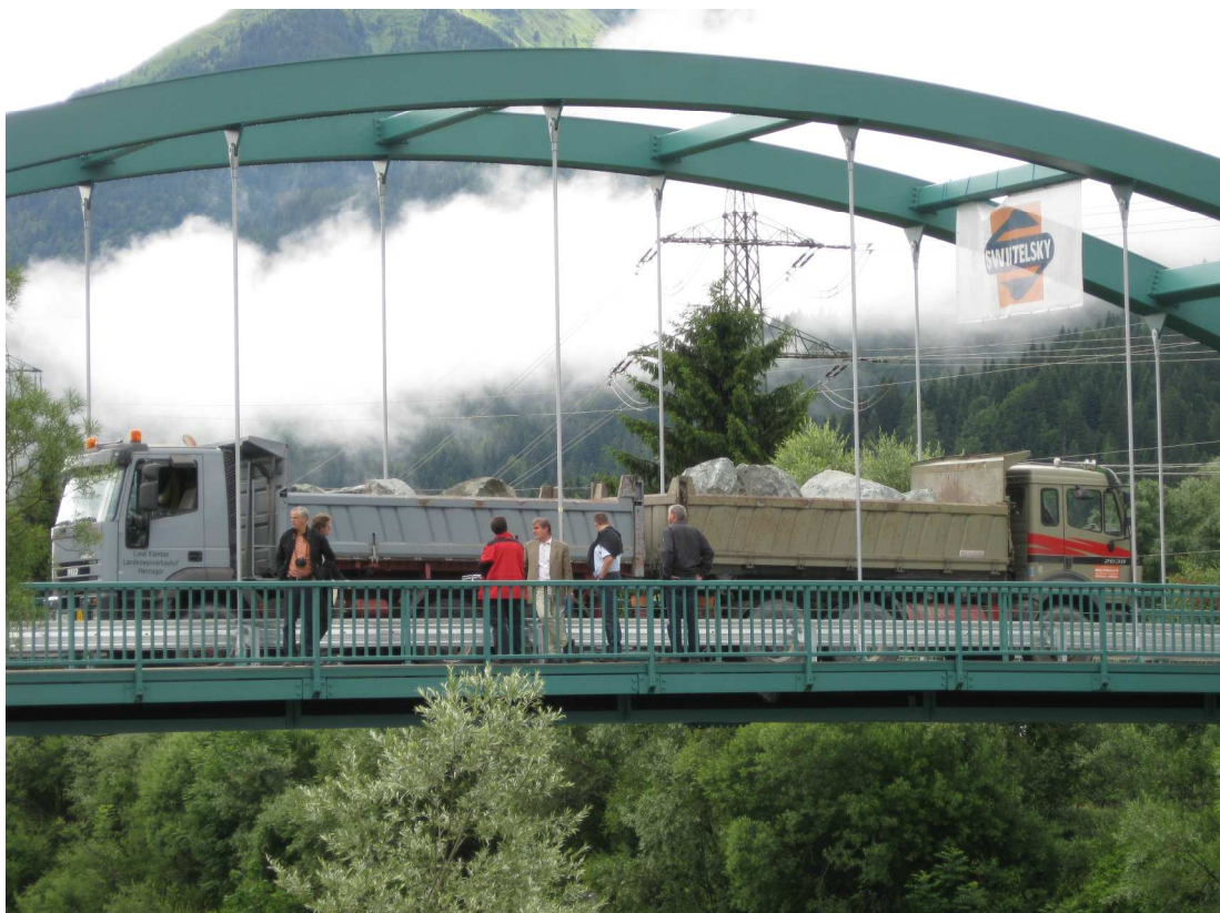
P7) Foto 14: S179-2008: Gailbrücke Gundersheim Belastungsprobe mit 2 x 50 To LKW Verkehrslast (L= 50 m)
