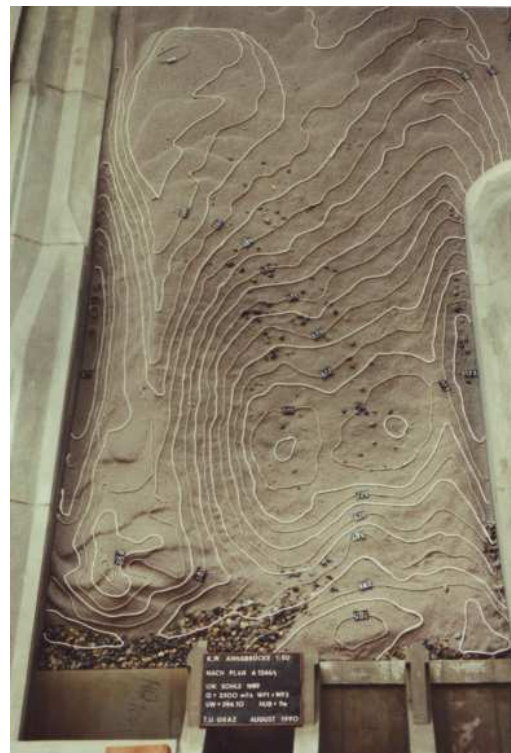
Draukraftwerk Annabrücke: Foto a) Ausfahren der Deckwalze Foto b) HQ 100 über n-1 Wehrfelder Foto b) zugehörige Kolkbilder im Unterwasser
