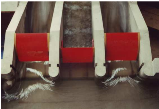
Draukraftwerk Annabrücke: Foto a) Ausfahren der Deckwalze Foto b) HQ 100 über n-1 Wehrfelder Foto b) zugehörige Kolkbilder im Unterwasser
