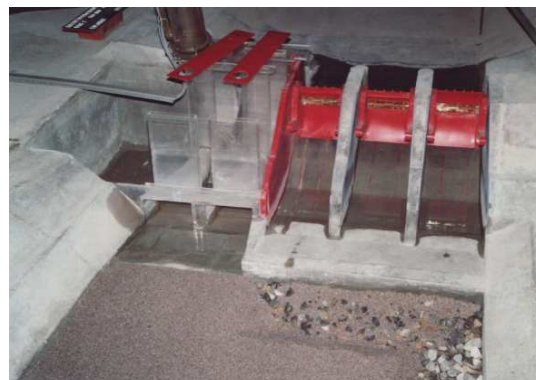
physikalisches Modell 1 : 50: Unterwasser
