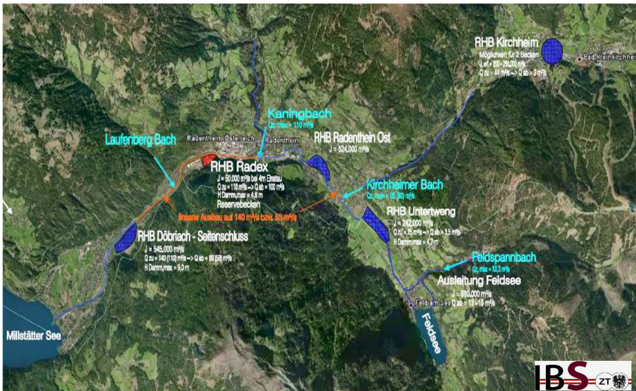
Machbarkeitsstudie mit Längsverbaumaßnahmen und der Planung von 4 Rückhalteanlagen für den Hochwasserschutz „Riegerbach“
